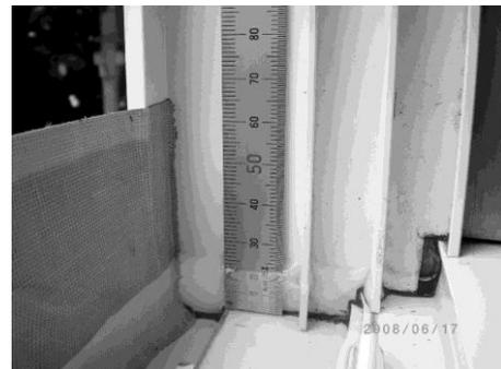
水張試験(サッシレール部分に水を溜めている)状況
