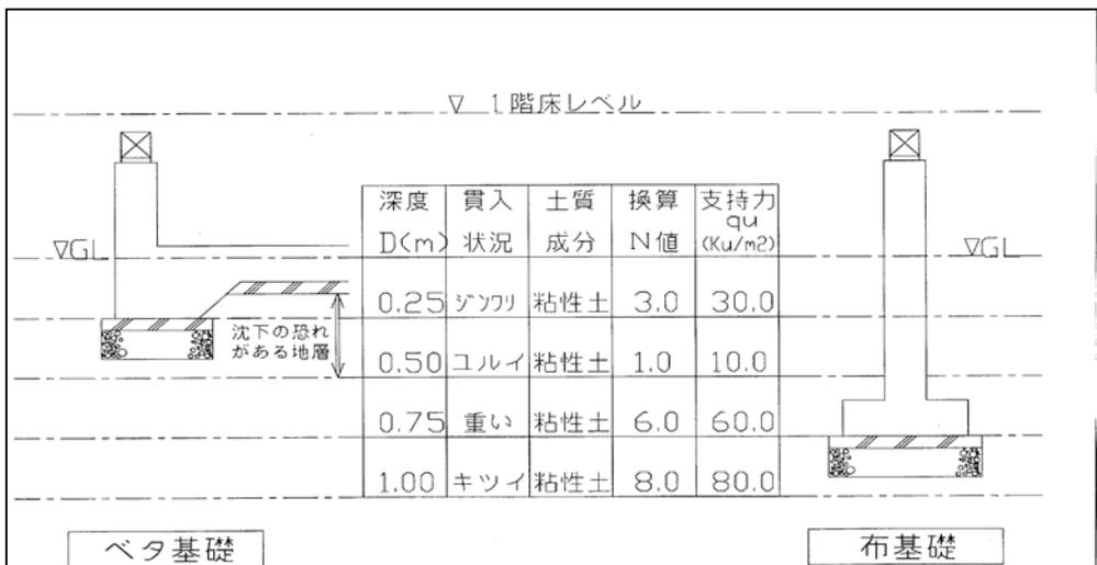
図に示す中央の表部分はスウェーデン式サウンディング試験 (SS 試験) と呼ばれる地盤調査試験データを抜粋したものです。この報告書の考察には「 $30 \text{ kN/m}^2$  (  $\approx 3.0 \text{ t/m}^2$  ) 基礎にて設計して下さい」と記載されておりました。
