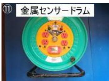
これは、コンクリートのコア抜きで、穿孔ドリルが鉄筋に触れた際に、瞬時に通電を遮断する機能を有する電工ドラムです。
