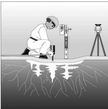
③ 床下に入った樹脂は、短時間で発泡する圧力で地盤を圧密強化し、地耐力を向上させる。
